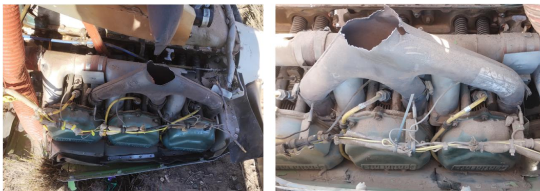
Figura 3. Daños en el motor (vista izquierda y derecha). Fuente: investigación JST
