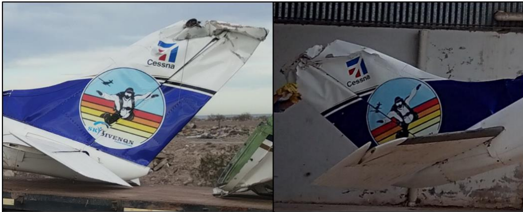
Figura 10. Daños en el estabilizador vertical y timón de dirección. Fuente: investigación JST
