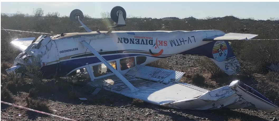
Figura 2. Daños en la célula. Fuente: investigación JST
