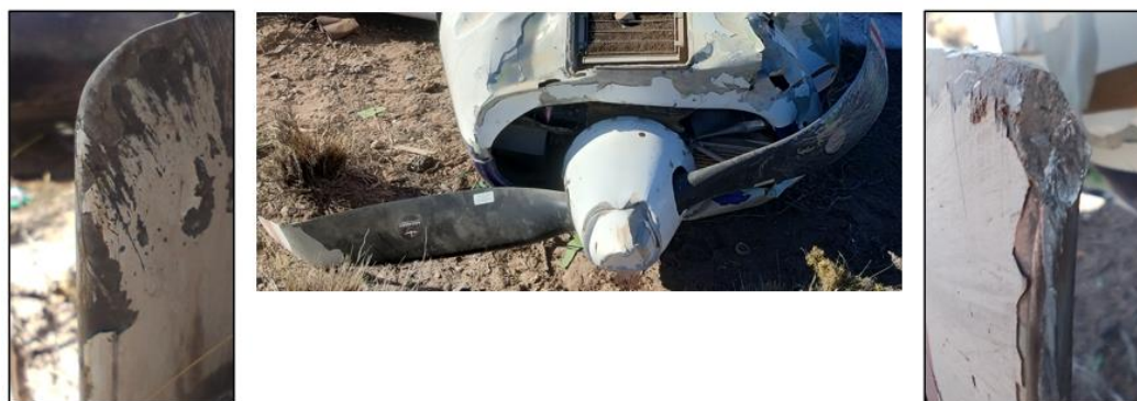
Figura 4. Daños en la hélice. Fuente: investigación JST
