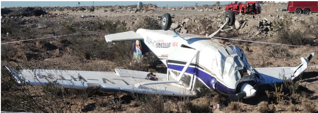
Figura 1. Daños en la célula. Fuente: investigación JST
