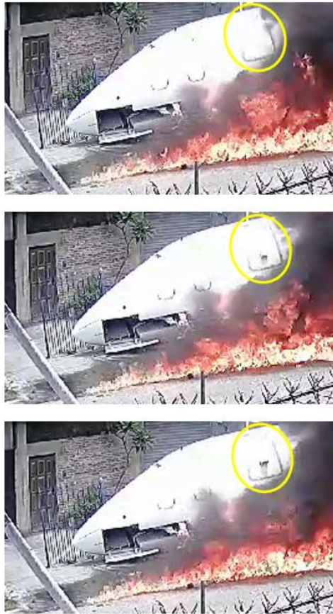
Figura 24. Activación de mecanismo de apertura de la puerta. Fuente: investigación JST.
