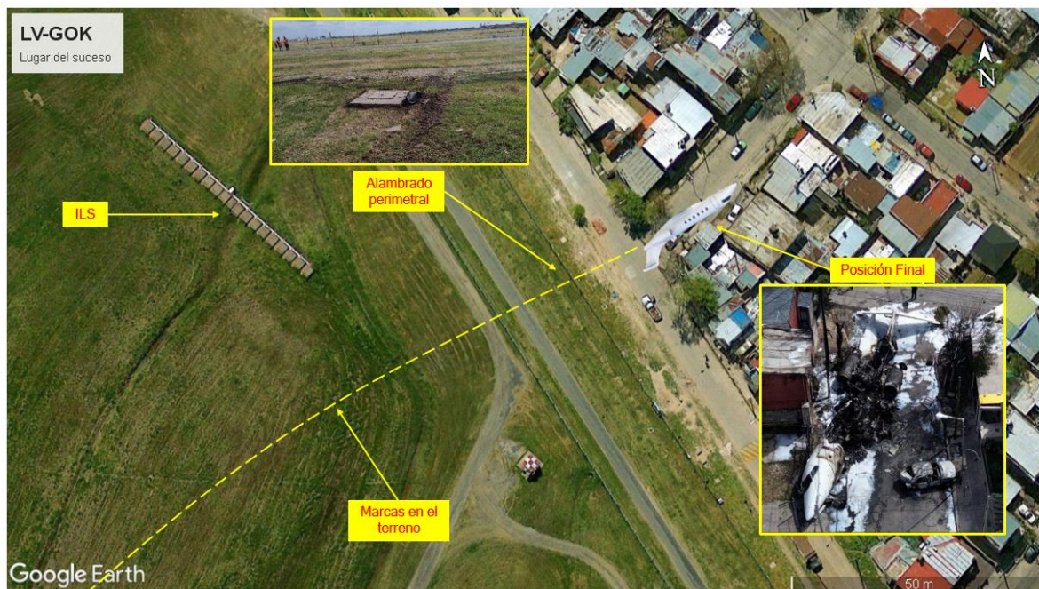
Figura 12. Detalle de la ubicación de los restos de la aeronave. Fuente: investigación JST
