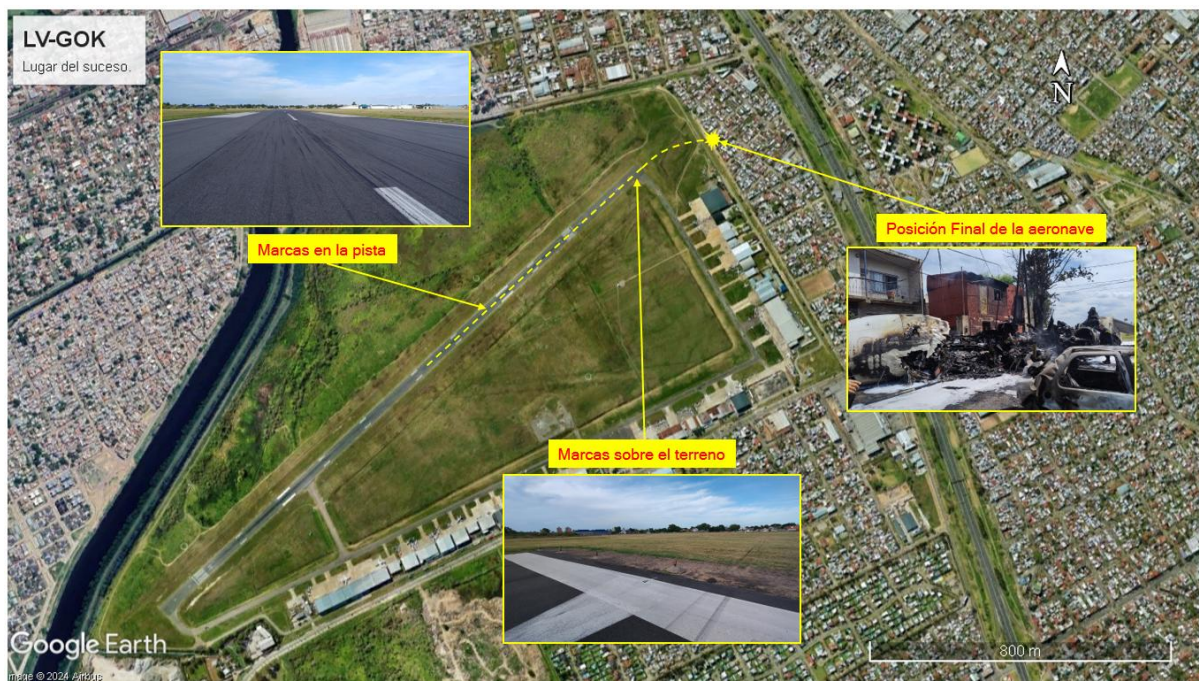
Figura 11. Trayectoria de la aeronave tras la toma de contacto con la pista. Fuente: investigación JST
