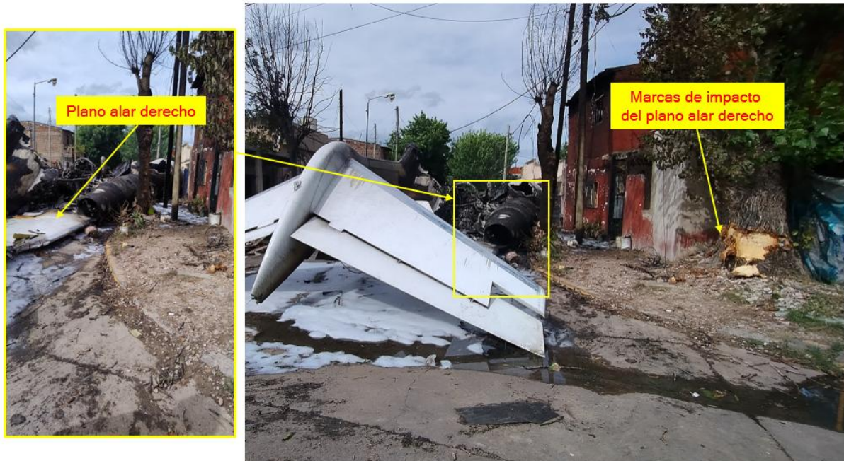
Figura 14. Detalle de las marcas en el terreno. Fuente: investigación JST
