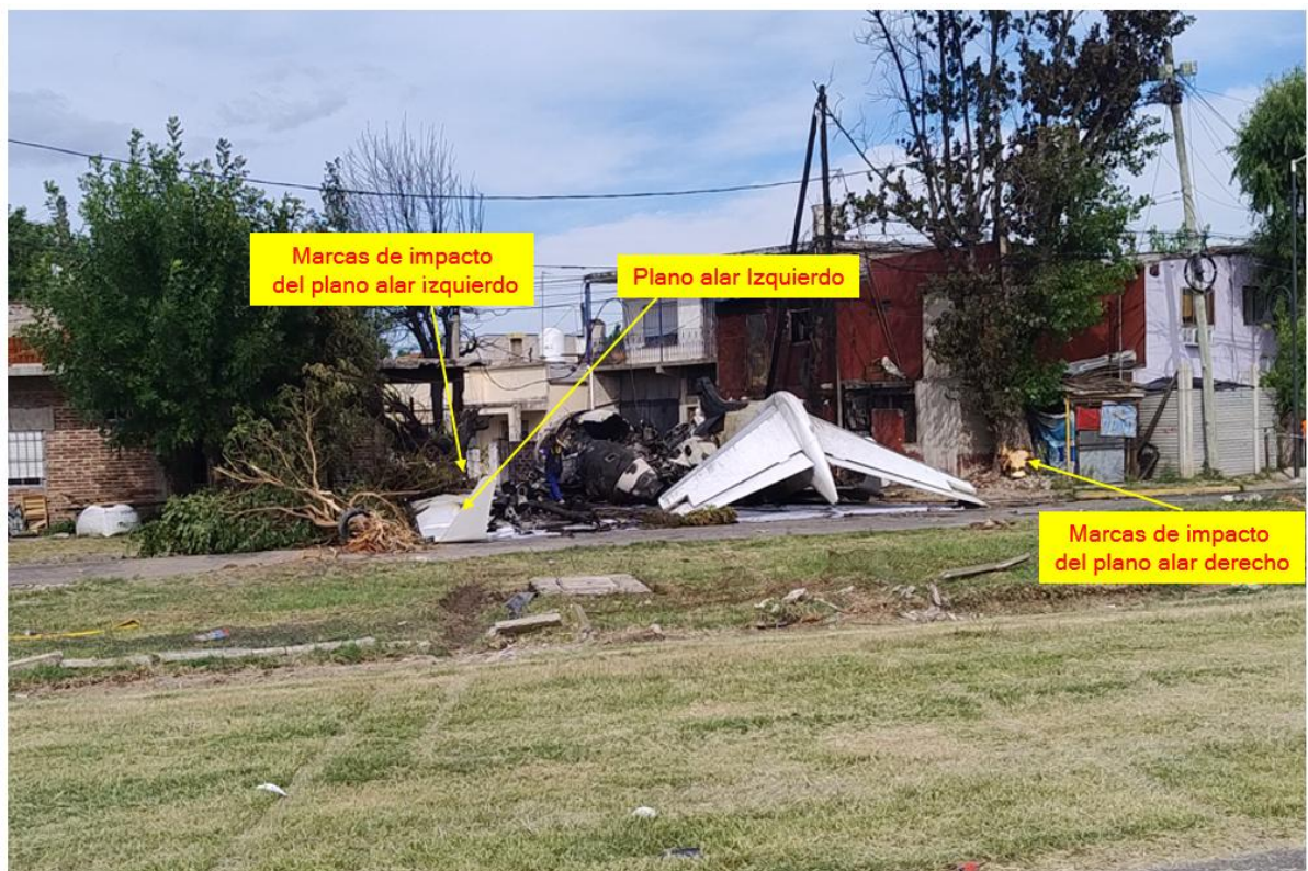
Figura 15. Detalle de las marcas en el terreno. Fuente: investigación JST
