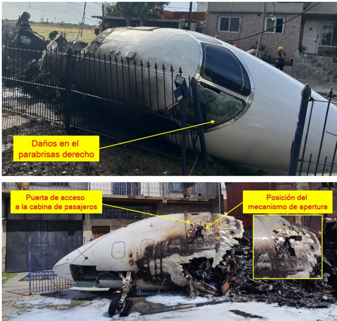
Figura 23. Condición de la cabina luego del suceso. Fuente: investigación JST
