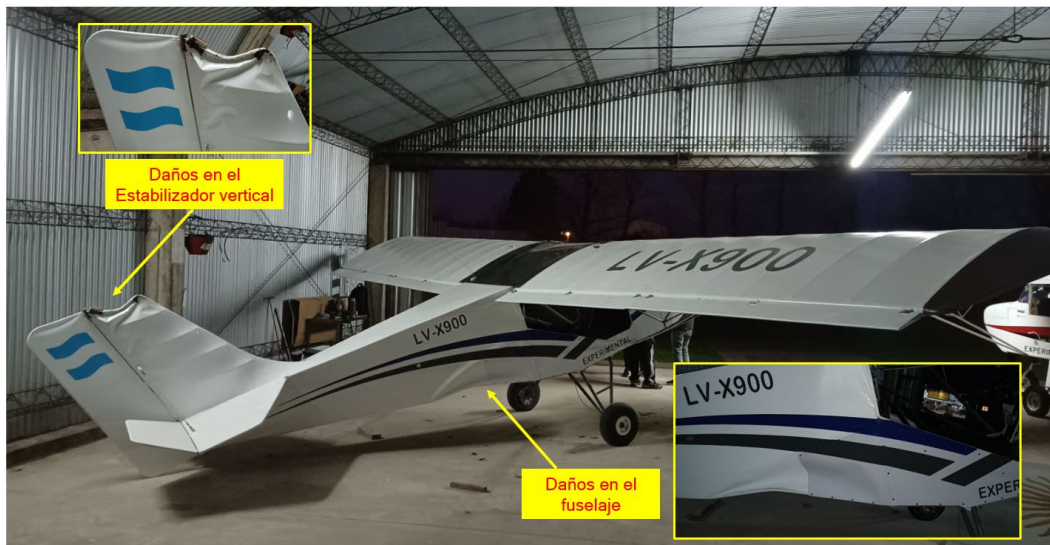
Figura 4. Daños en el fuselaje y el estabilizador vertical. Fuente: investigación JST
