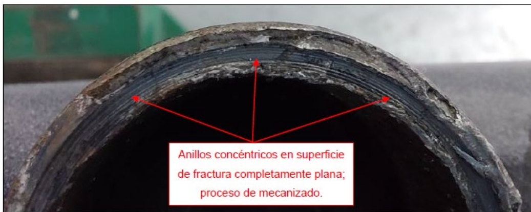
Figura 11. Detalle de la zona de fractura - imagen B. Fuente: investigación JST
