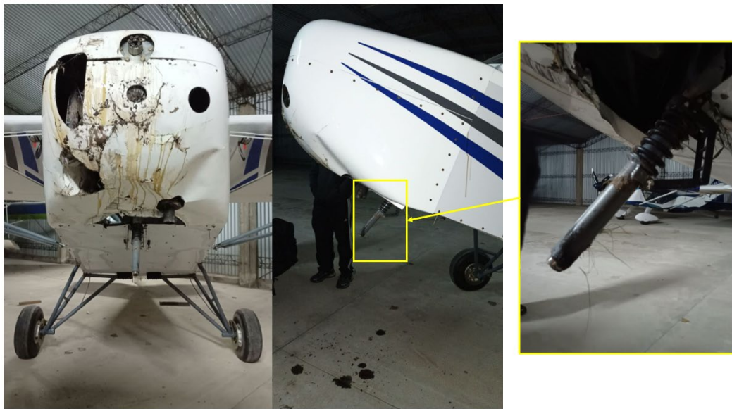
Figura 5. Daños en el morro y el tren de aterrizaje de nariz. Fuente: investigación JST
