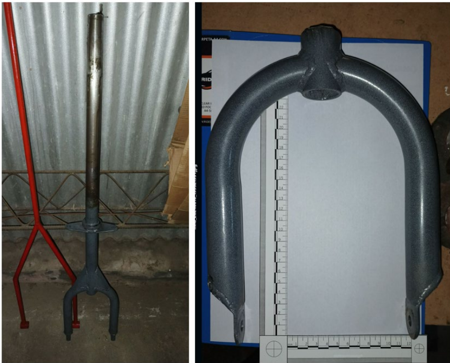
Figura 2. Conjunto de eje y horquilla utilizado en el primer vuelo de prueba / Sección de la horquilla instalada al momento del suceso. Fuente: investigación JST
