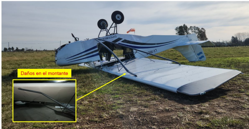
Figura 3. Daños en el montante alar. Fuente: investigación JST
