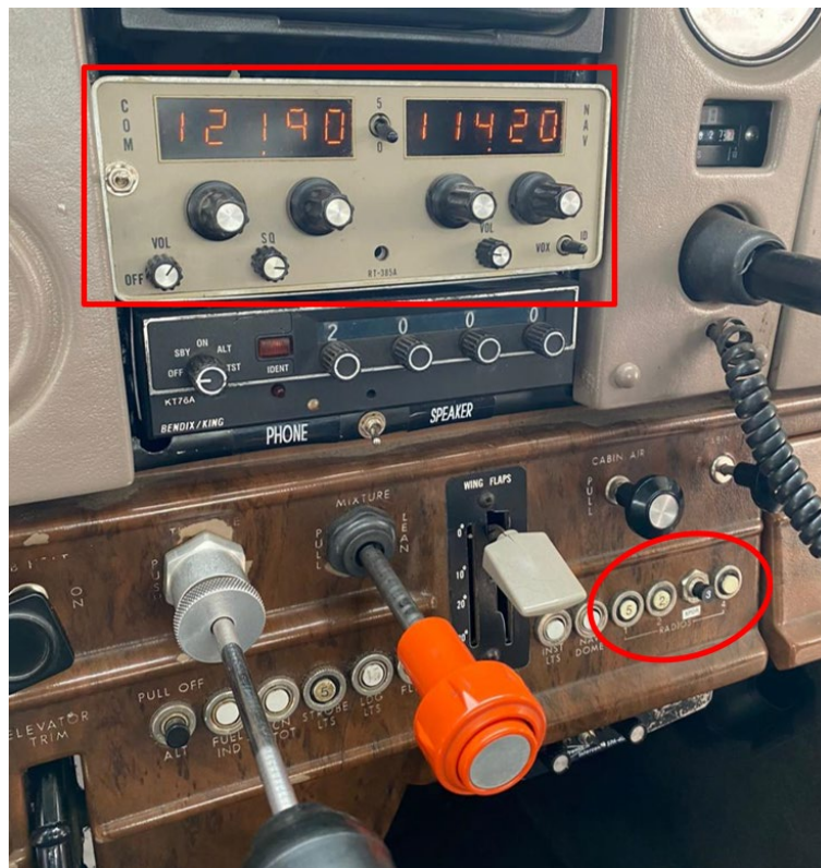
Figura 4. Equipo de comunicación y navegación RT-385A, y su correspondiente panel de fusibles. Fuente: investigación JST
