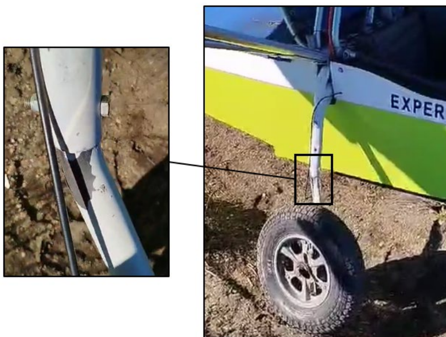
Figura 5. Detalle de los daños en el tren de aterrizaje derecho. Fuente: investigación JST
