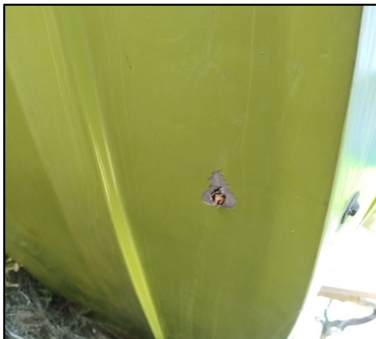
Figura 6. Detalle de los daños en la zona ventral. Fuente: investigación JST
