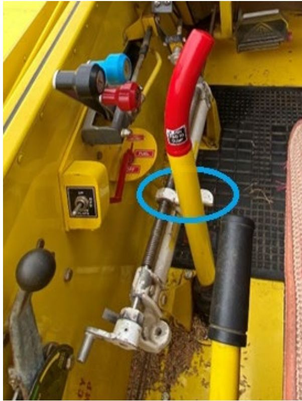
Figura 8. Recorrido hasta la traba de la palanca de descarga de emergencia de la tolva.
