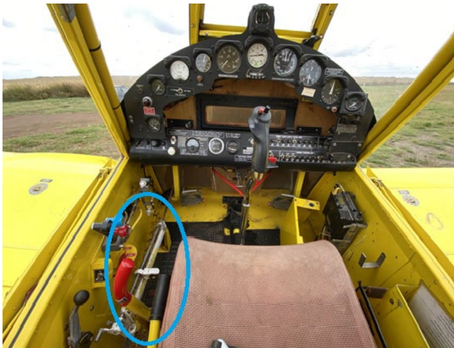
Figura 5. Cabina de la aeronave y sistema de descarga de emergencia de la tolva. Fuente: investigación JST
