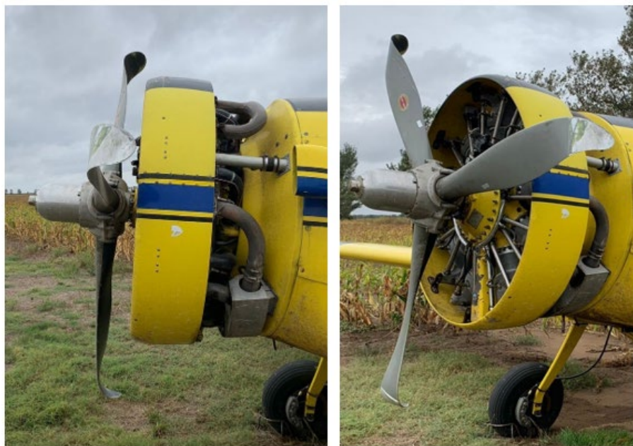
Figura 4. Daños en las palas de la hélice. Fuente: investigación JST
