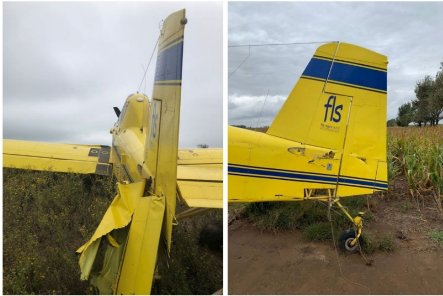
Figura 3. Daños en el estabilizador horizontal. Fuente: investigación JST
