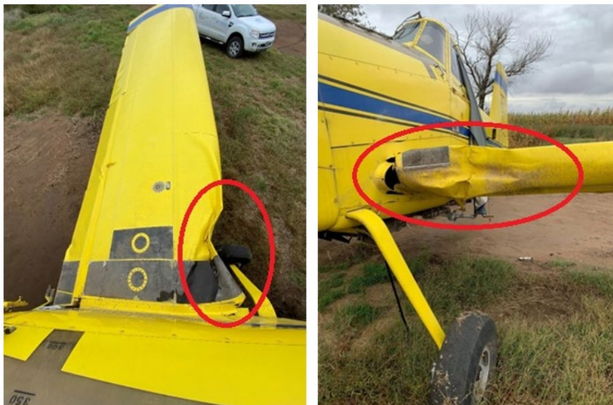
Figura 2. Daños en el ala izquierda producto del impacto con un árbol. Fuente: investigación JST
