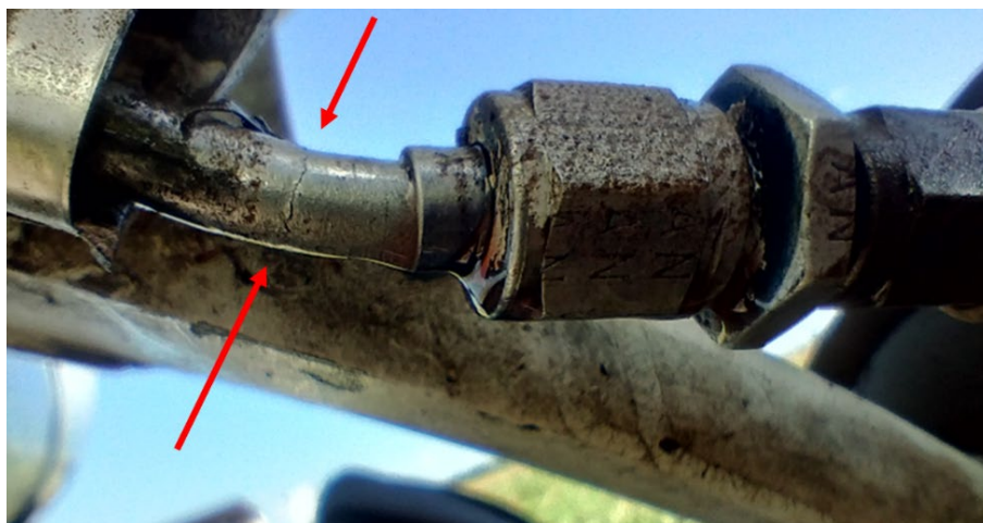
Figura 7 Fisura en el circuito de frenos. Fuente: investigación JST
