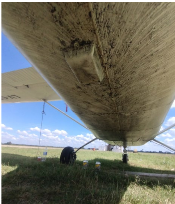
Figura 10. Rastros de aceite en zona ventral del fuselaje. Fuente: investigación JST
