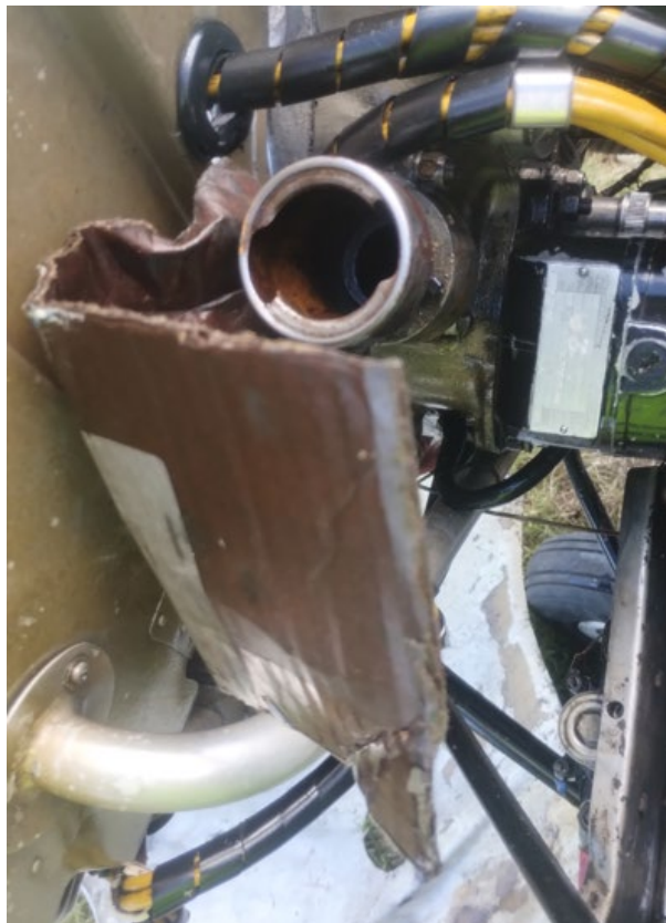
Figura 9. Ausencia del tapón de aceite. Fuente: investigación JST
