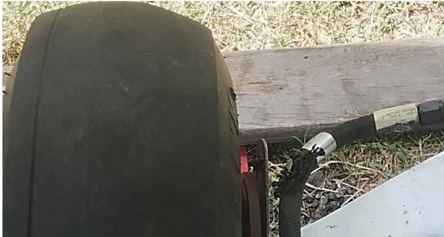
Figura 8. Neumático gastado y flexible deteriorado. Fuente: investigación JST
