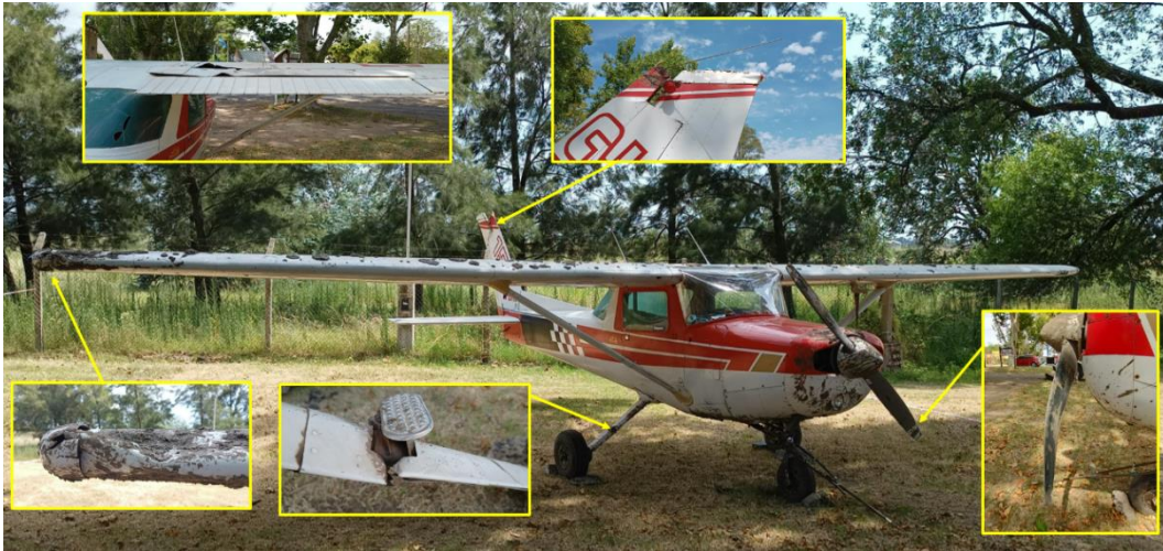
Figura 4. Daños en la aeronave. Fuente: investigación JST
