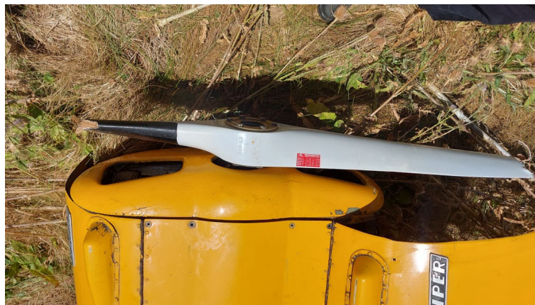
Figura 5. Daños en la hélice. Fuente: investigación JST
