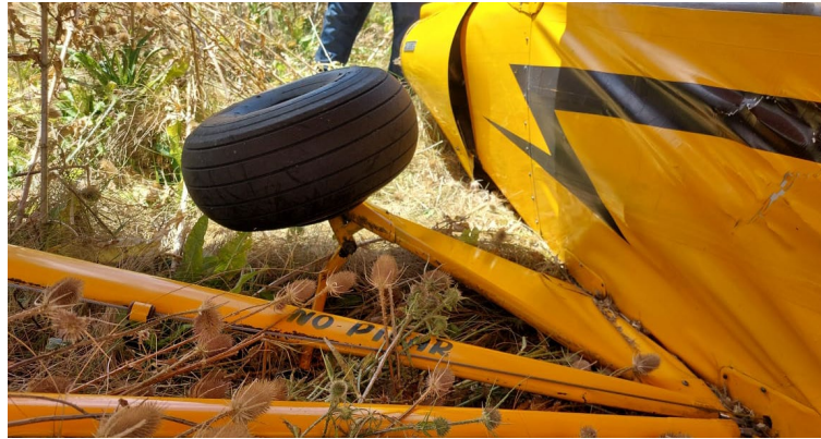
Figura 4. Daños en el tren principal izquierdo. Fuente: investigación JST
