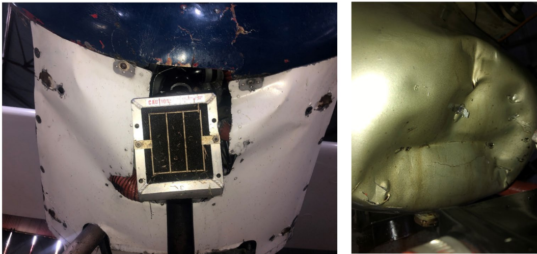
Figura 3. Daños en filtro de aire y cárter de aceite. Fuente: investigación JST
