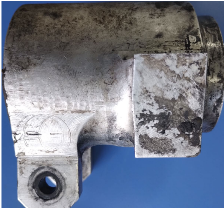
Figura 8. Detalle de marcas de herramienta y bordes irregulares en el housing del LV-ONS.
