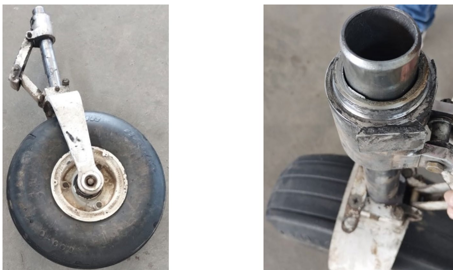
Figura 6. Fractura en el housing del tren de nariz del LV-ONS. Fuente: investigación JST
