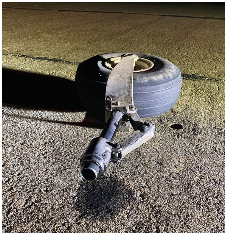
Figura 5. Estructura del tren de nariz desprendido. Fuente: investigación JST
