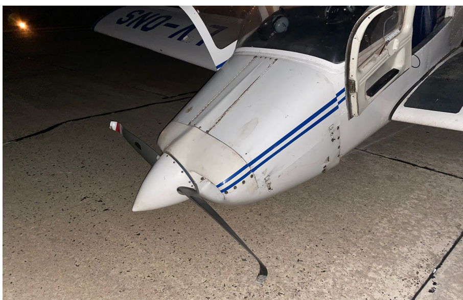
Figura 3. Daños en la hélice. Fuente: investigación JST
