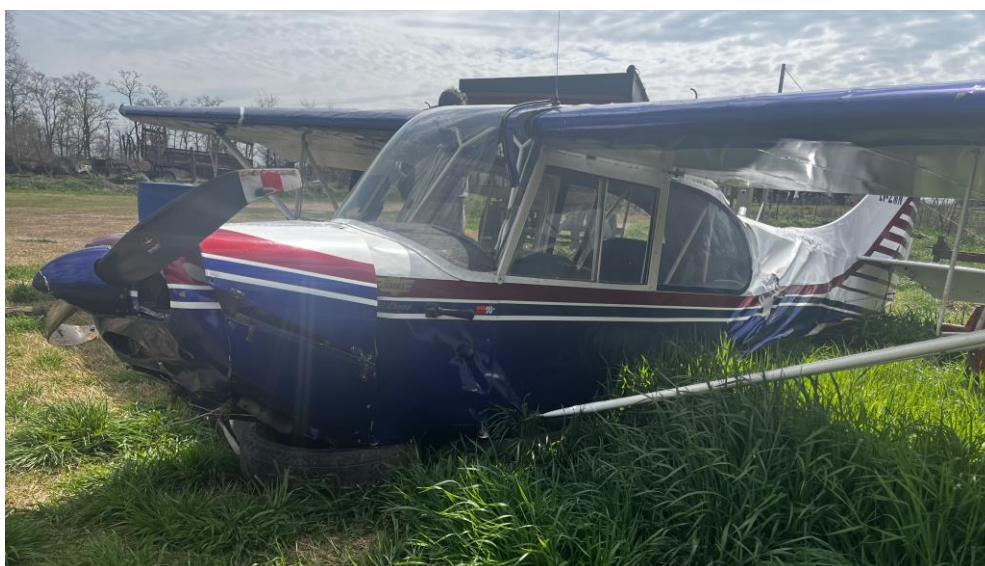
Figura 3. Daños en la aeronave. Fuente: investigación JST
