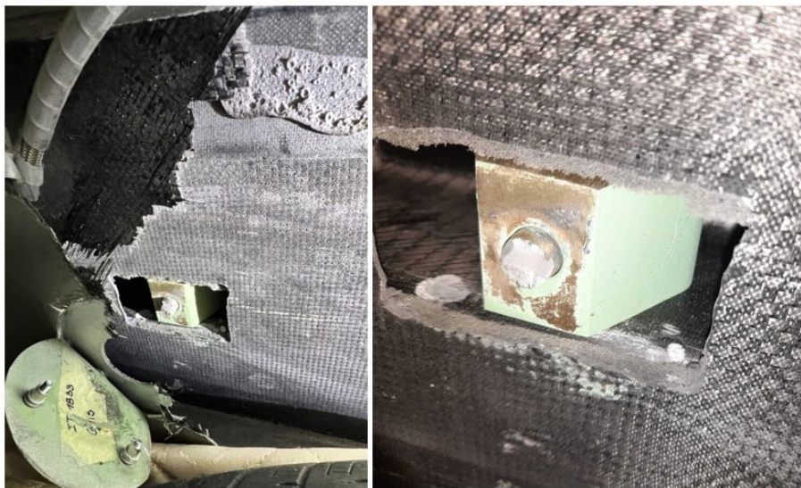
Figura 3. Daños en el fuselaje, zona de anclaje del tren principal derecho. Fuente: investigación JST
