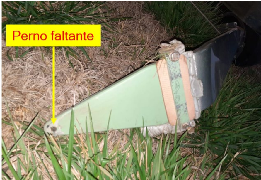
Figura 9. Anclaje desprendido. Fuente: investigación JST
