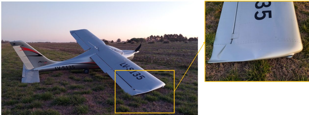
Figura 4. Daños en la puntera del ala. Fuente: investigación JST
