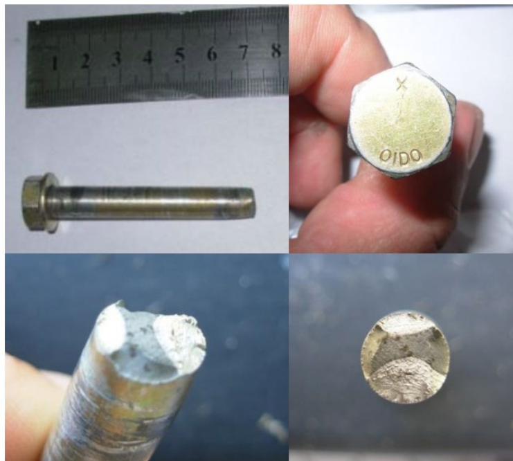
Figura 11. Perno de sujeción del tren principal. Fuente: Catalogo de partes Ilustrado
