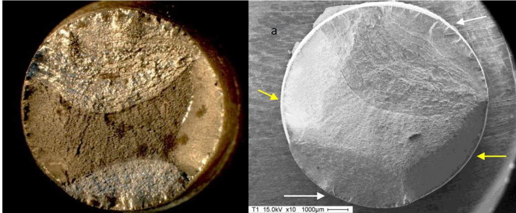
Figura 13. Superficie de la fractura vista por microscopio óptico (izquierda), y microscopio electrónico (derecha). Fuente: investigación JST
