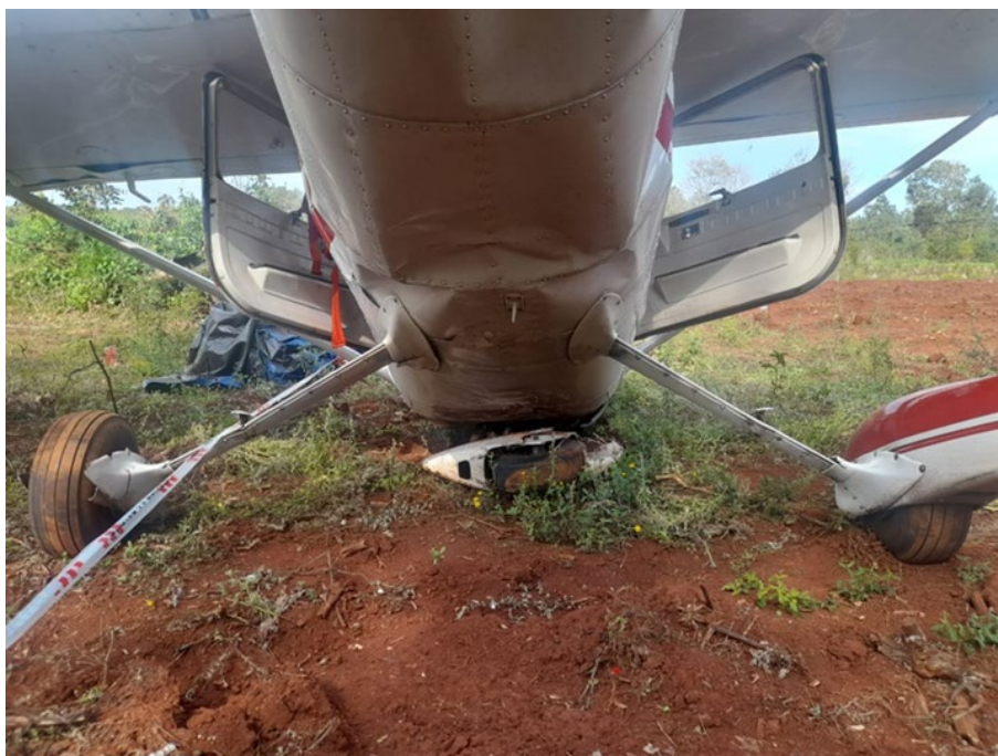
Figura 5. Daños en el tren de aterrizaje de nariz y en el tren principal. Fuente: investigación JST
