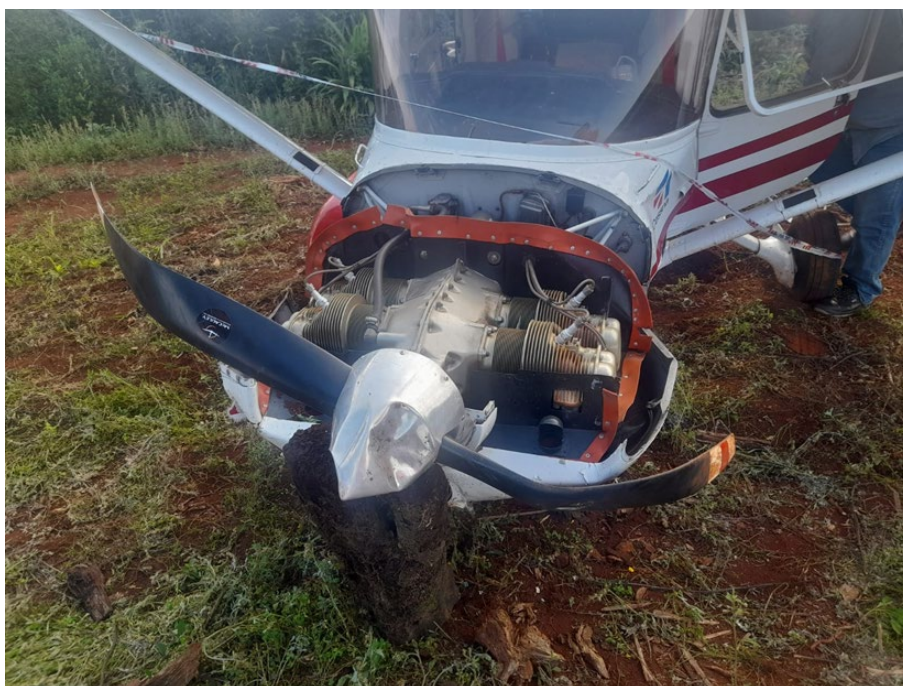
Figura 4. Daños de importancia en el motor y la hélice. Fuente: investigación JST
