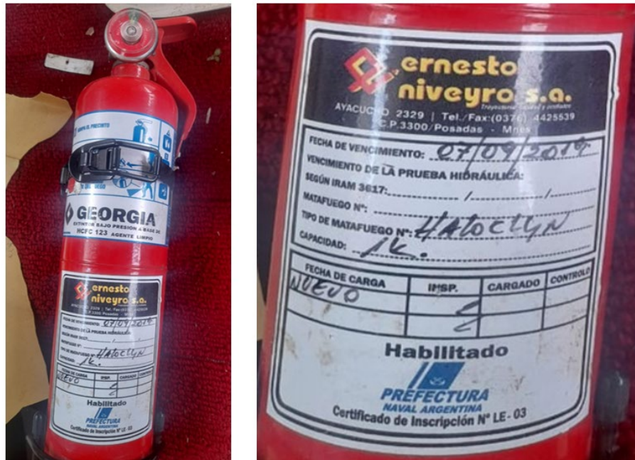
Figura 6. Extintor que equipaba la aeronave. Fuente: investigación JST
