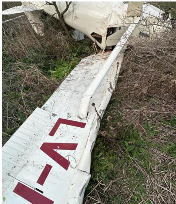
Figura 3. Daños en la célula de la aeronave. Fuente: investigación JST
