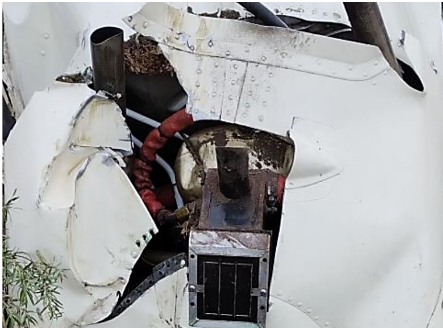
Figura 6. Daños en el motor de la aeronave. Fuente: investigación JST
