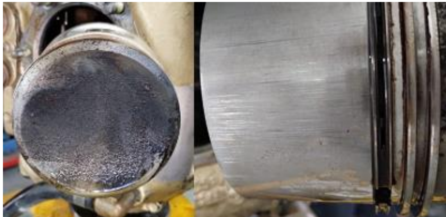
Figura 18. Estado del pistón del cilindro 3. Fuente: investigación JST
