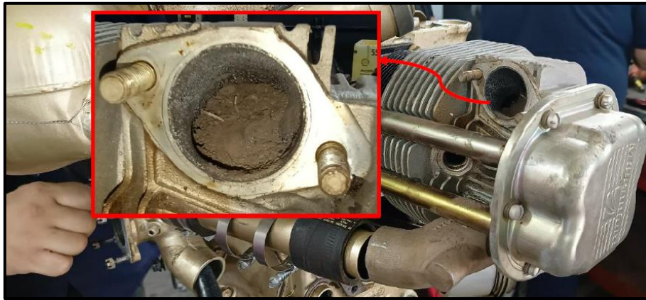
Figura 20. Estado del pistón del cilindro 1. Fuente: investigación JST
