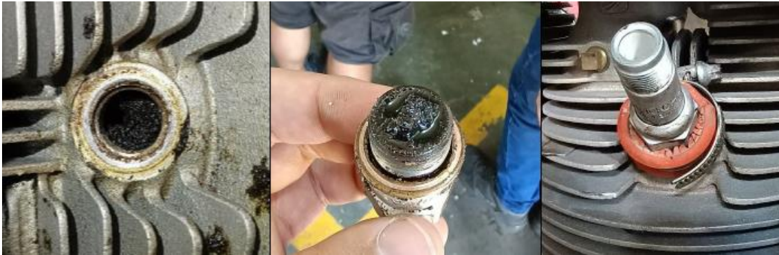
Figura 15. Detalle del interior del cilindro 3, bujía superior 3 contaminada, bujía superior 1 con goma y abrazadera. Fuente: investigación JST
