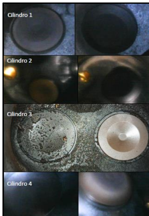
Figura 21. Estado de válvulas del motor. Fuente: investigación JST
