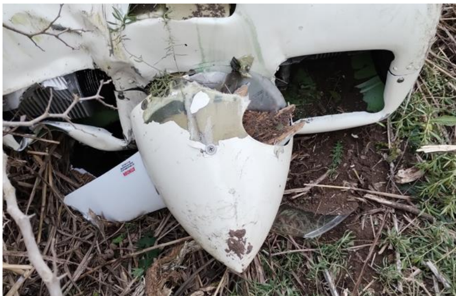
Figura 7. Daños en la hélice de la aeronave. Fuente: investigación JST
