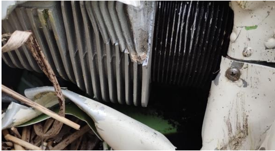
Figura 5. Daños en el motor de la aeronave. Fuente: investigación JST
