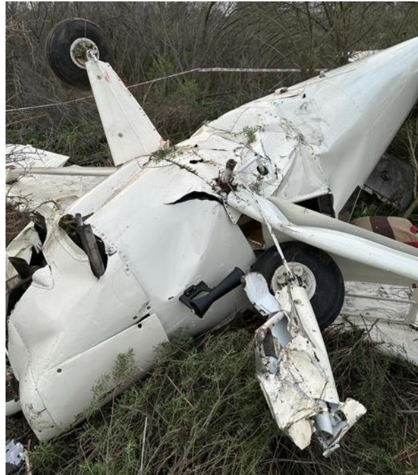
Figura 2. Daños en la célula de la aeronave. Fuente: investigación JST
