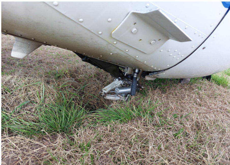
Figura 2. Vista del tren de nariz del LV-INK dentro del hormiguero. Fuente: investigación JST
