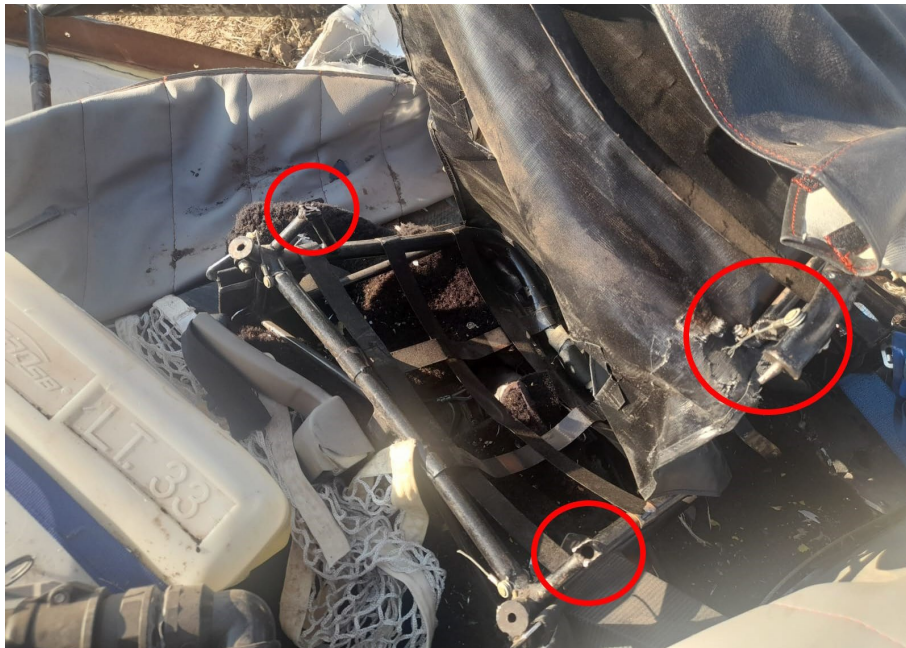
Figura 10. Daños en el sistema de anclaje de la butaca de vuelo. Fuente: investigación JST
