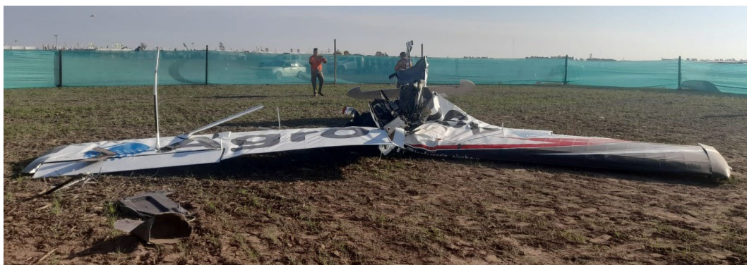
Figura 7. Posición final de la aeronave y sus partes. Fuente: investigación JST
