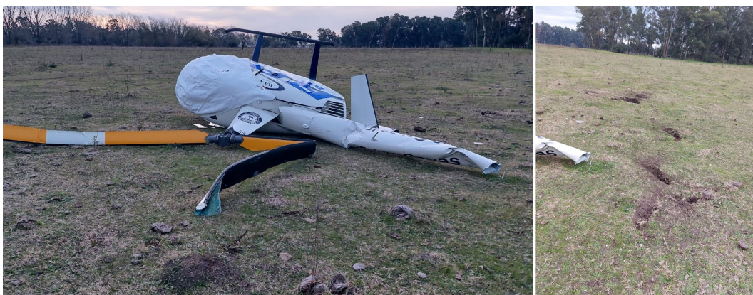
Figura 13. Daños en la aeronave y marcas sobre el terreno. Fuente: investigación JST
