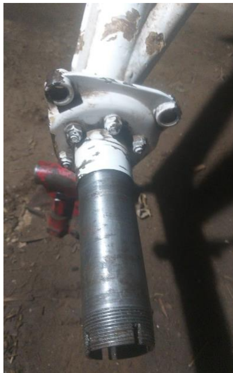
Figura 9. Eje del tren principal izquierdo del LV-MNB. Fuente: investigación JST
