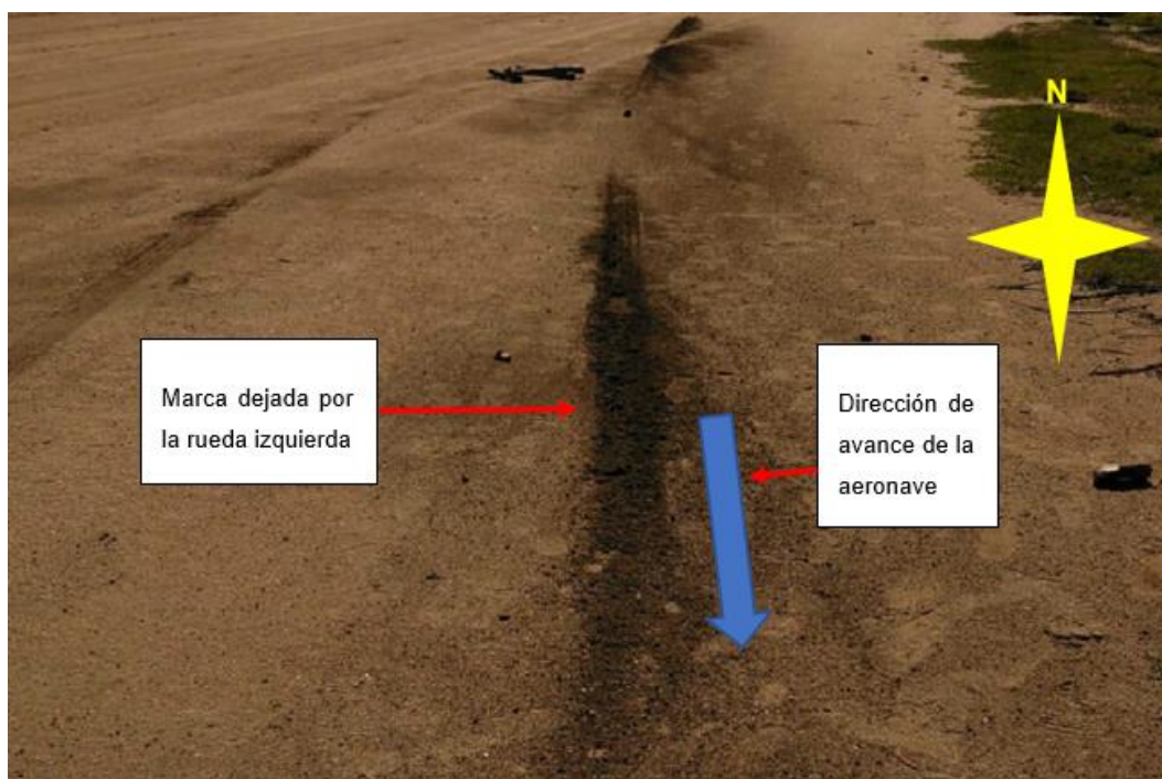
Figura 5. Marcas de las ruedas del tren de aterrizaje en la pista antes del impacto. Fuente: investigación JST
