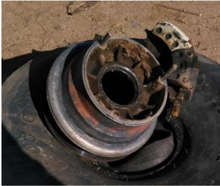
Figura 6. Media llanta interior de la rueda izquierda. Fuente: investigación JST
