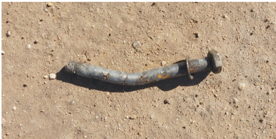
Figura 7. Uno de los tres pernos que unían las dos medias llantas de la rueda izquierda.
