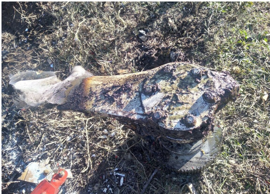
Figura 3. Daños en la hélice. Fuente: investigación JST
