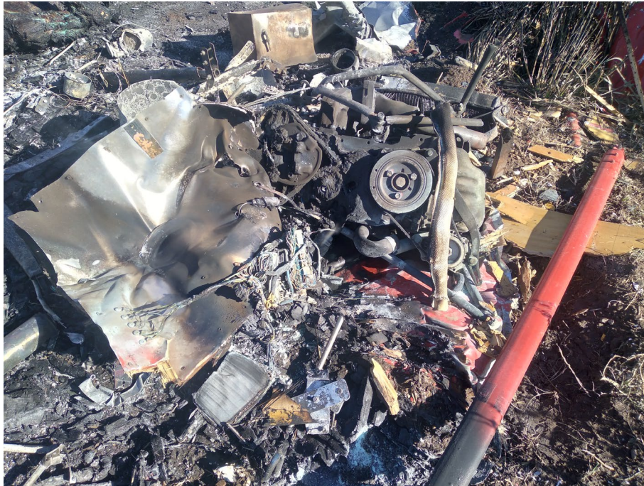
Figura 2. Daños en el motor. Fuente: investigación JST
