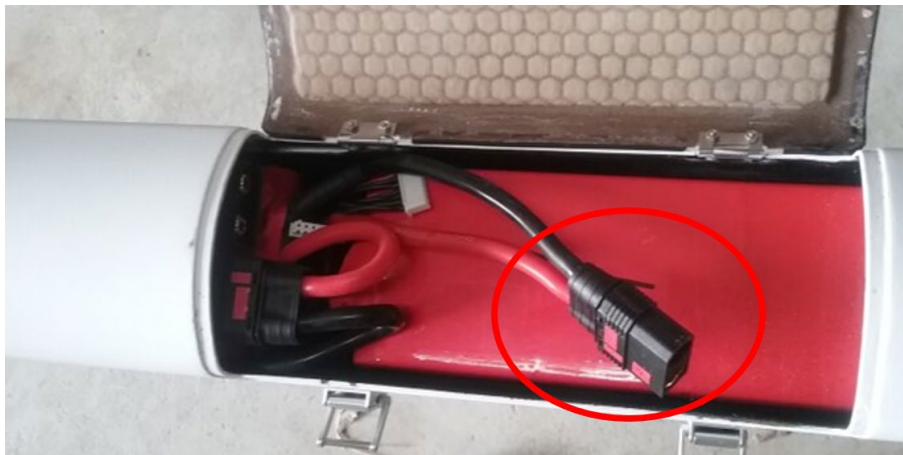
Figura 7. Conector de batería. Fuente: investigación JST
