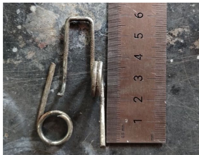
Figura 11. Resorte fracturado. Fuente: investigación JST
