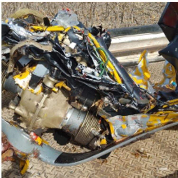
Figura 3. Daños en el motor y hélice. Fuente: investigación JST
