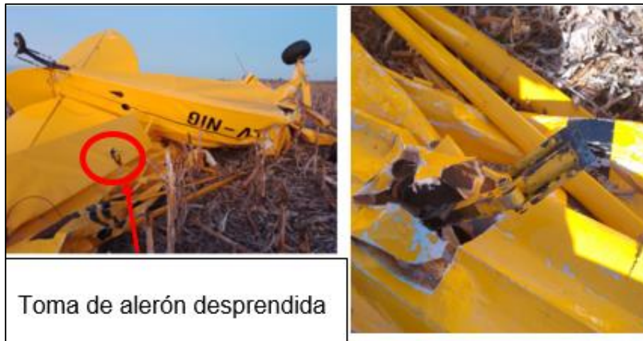
Figura 12. Detalle de la toma interna del alerón izquierdo en la aeronave LV-NIG. Fuente: investigación JST
