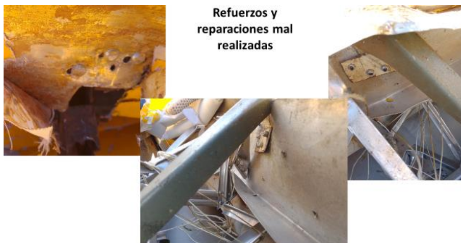
Figura 16. Reparaciones de alerones no estandarizadas. Fuente: investigación JST
