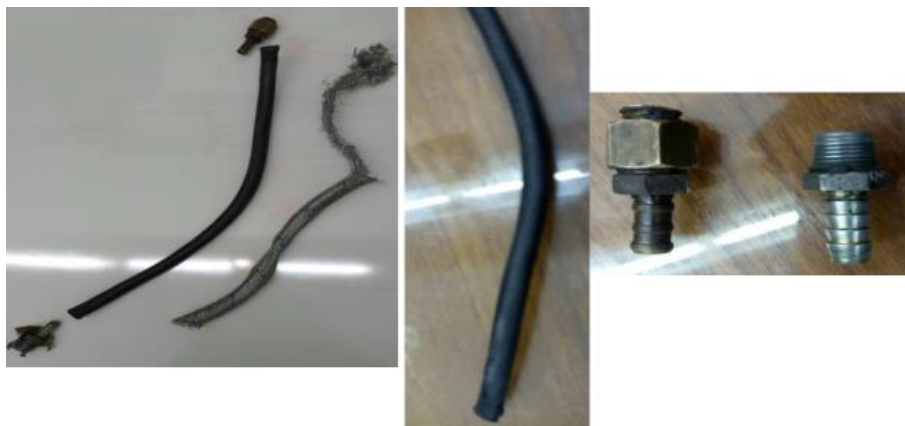
Figura 17. Manguera de combustible instalada en el LV-NIG. Fuente: investigación JST
