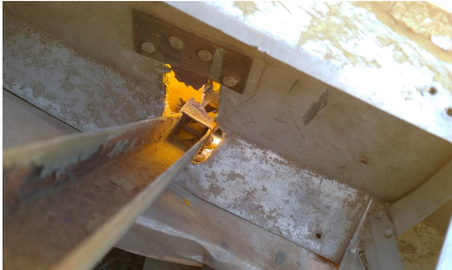
Figura 15. Rotura del Aileron Hinge Reinforcing Bracket del LV-NIG. Fuente: investigación JST
