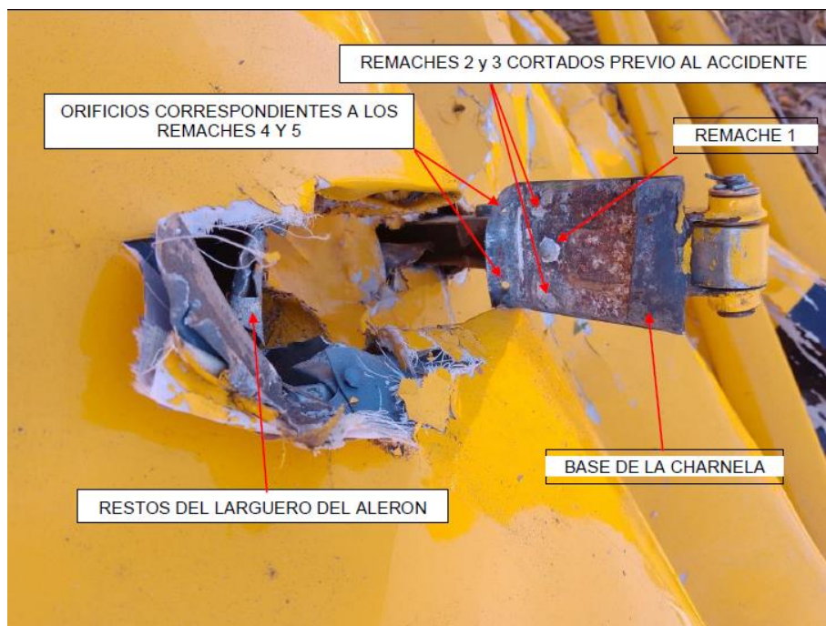
Figura 13. Detalles de la condición de la toma de alerón. Fuente: investigación JST
