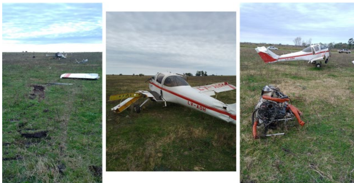
Figura 1. Daños en la aeronave. Fuente: investigación JST
