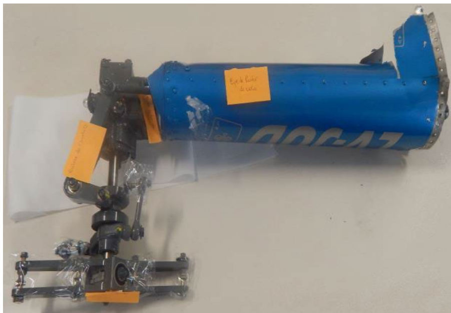
Figura 17. Conjunto de cono de cola. Fuente: informe de FAdeA
