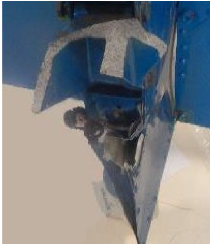
Figura 19. Fijación del estabilizador al cono de cola. Fuente: informe de FAdeA
