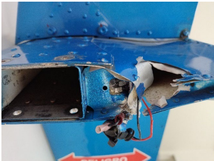
Figura 14. Impronta generada por impacto. Fuente: informe de FAdeA
