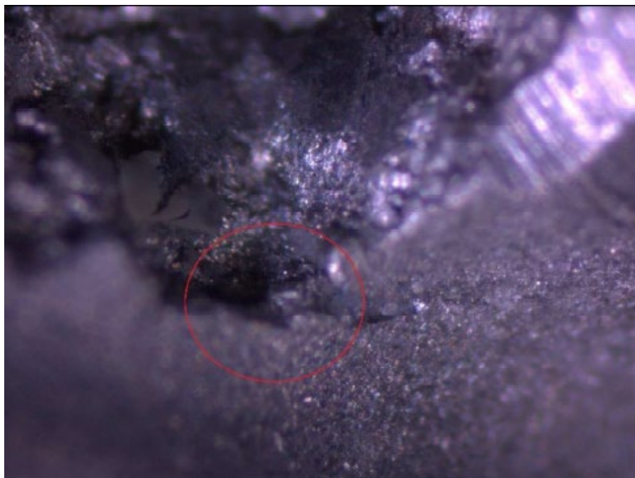
Figura 21. Cavity por contracción. Fuente: informe de FAdeA
