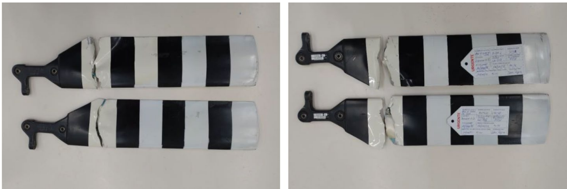
Figura 10. Palas de rotor de cola. Fuente: informe de FAdeA
