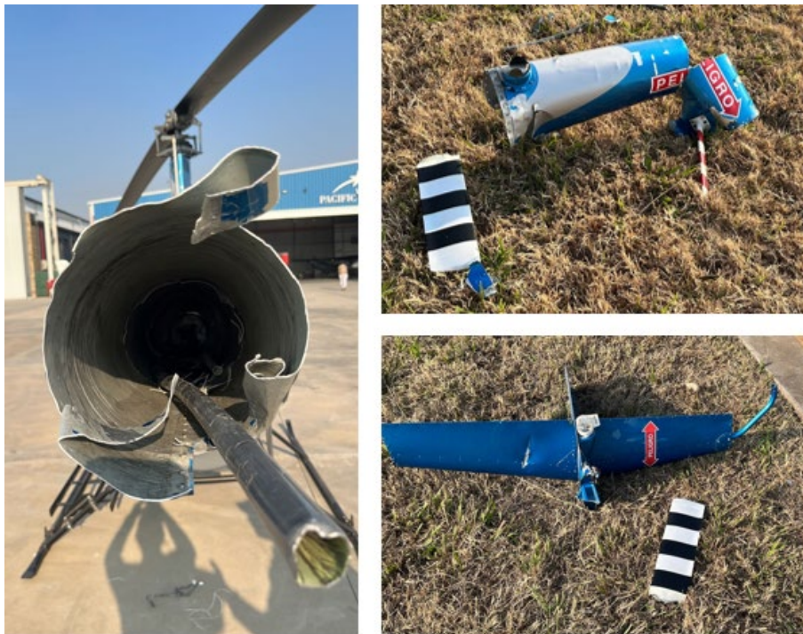
Figura 1. Vista trasera del LV-JUD y partes desprendidas. Fuente: investigación JST
