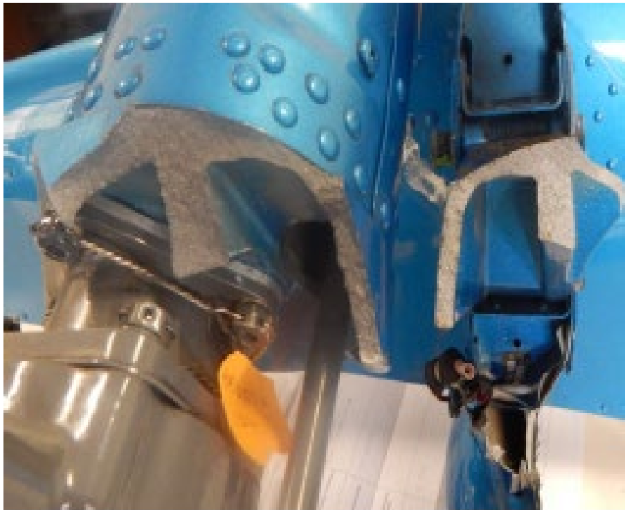
Figura 20. Segmento fracturado. Fuente: informe de FAdeA
