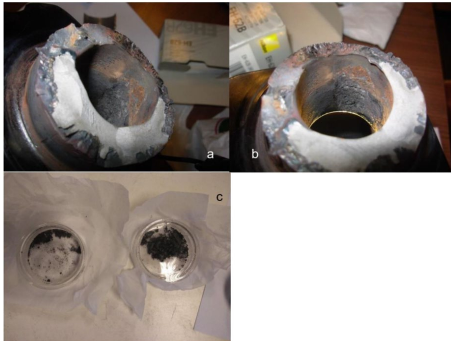
Figura 7. Detalle de fractura frágil intencional y fractura el día del suceso (a y b). Sedimento removido (c). Fuente investigación JST
