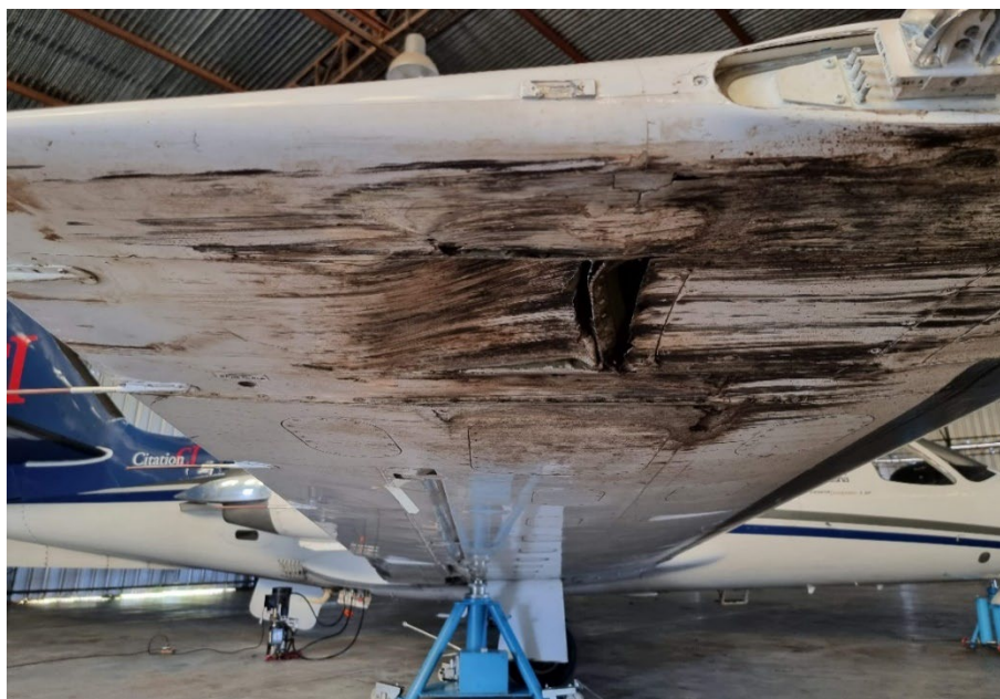
Figura 5. Daños en puntera de ala derecha. Fuente: investigación JST
