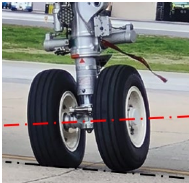
Figura 33. Posición final del tren de nariz con líneas de referencia del suelo (negra) y línea de eje del tren de nariz (roja). Fuente: investigación JST
