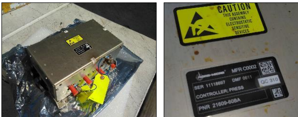
Figura 2. Controlador de presión desmontado del LV-CIF (P/N: 21609-60BA, S/N: 11118697). Fuente: investigación JST
