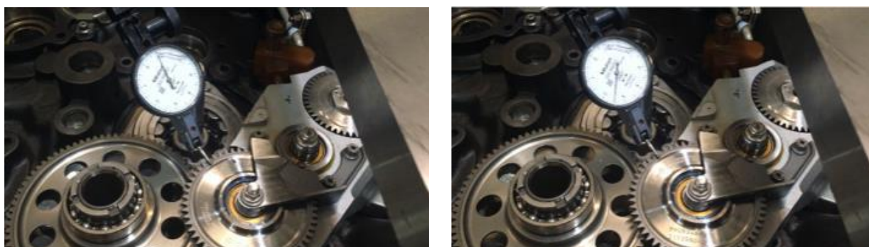
Figura 4. Comprobación de giro en el plano de los engranajes del sensor de torque
