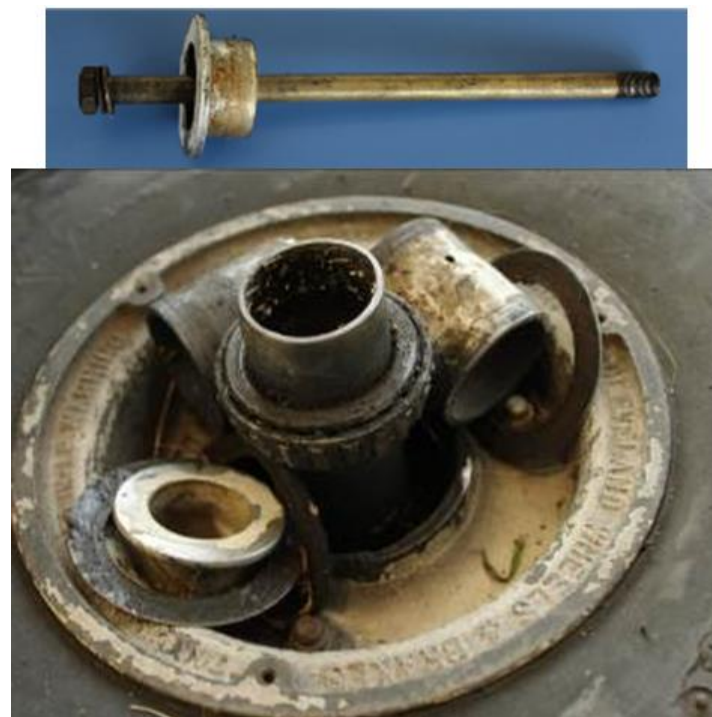
Figura 4. Elementos de montaje de la rueda
